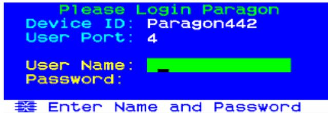
Wird auf dem Monitor ein Hinweis angezeigt, dass keine Verbindung zum Paragon-System besteht, ist die Benutzerstation nicht korrekt am Paragon-Switch angeschlossen. Überprüfen Sie die Kabelverbindungen, und vergewissern Sie sich, dass die Cat5-Kabel nicht beschädigt sind.
