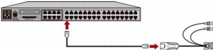
2. Abhängig vom erworbenen CIM-Modell müssen Sie die CIM-Stecker an die PS/2- oder USB-Tastatur-, -Maus- oder VGA-Ports eines Servers anschließen.
