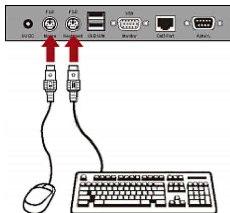
**警告：**切勿同时连接 PS/2 和 USB 键盘，切勿同时连接 PS/2 和 USB 鼠标，否则只有 USB 键盘和/或鼠标能正常工作。
