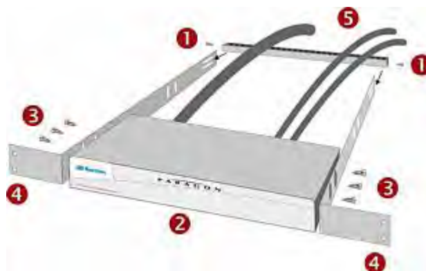
正面机架安装
