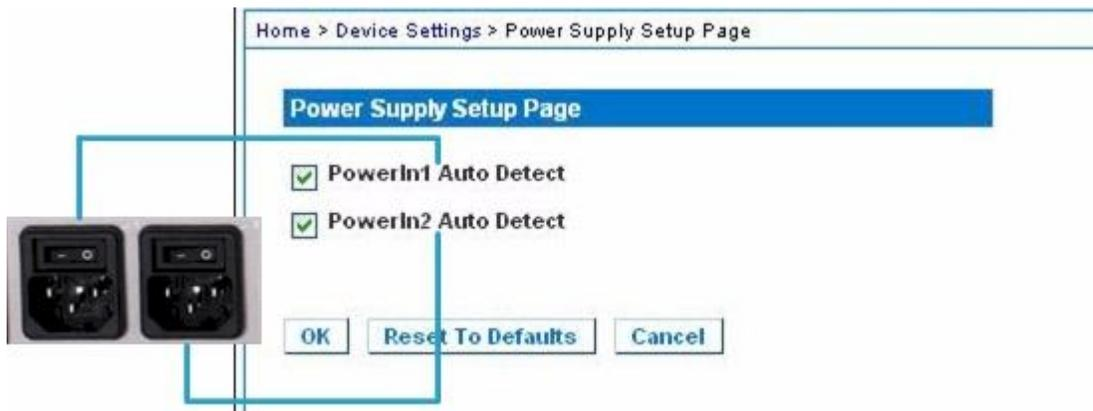
2. Si vous branchez une arrivée électrique dans l'alimentation numéro un (la plus à gauche à l'arrière de l'unité), sélectionnez l'option PowerIn1 Auto Detect (Détection automatique PowerIn1).
