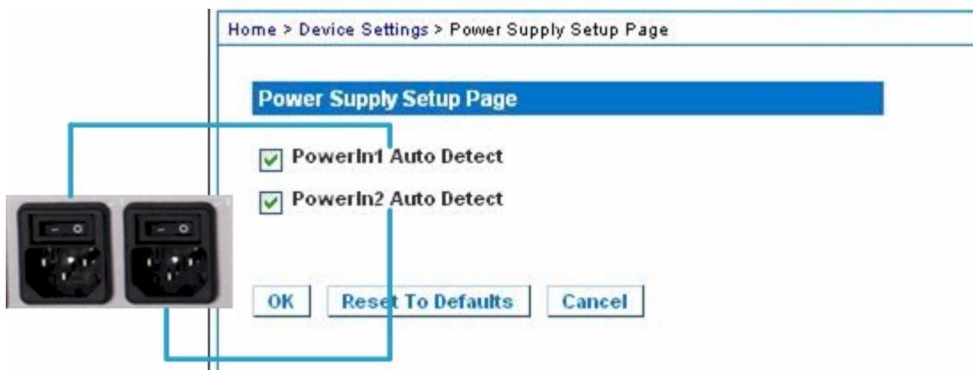
2. 如果要將電源輸入插入一號電源 (裝置背面最左邊的電源供應)，請選取「PowerIn1 Auto Detect」(自動偵測一號電源) 選項。
