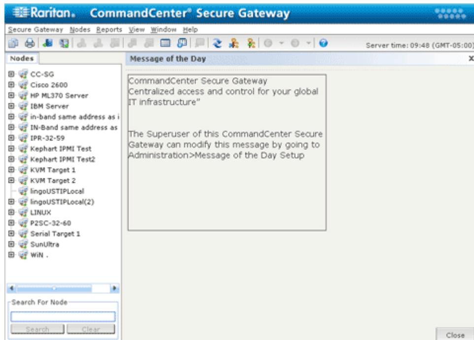
1. **Nodes (节点)** 选项卡：单击 **Nodes (节点)** 选项卡，按树视图形式显示所有节点。接口在父节点下组合在一起。单击 + 号和 - 号展开或折叠树视图。单击一个节点，查看 **Node Profile (节点配置文件)**。用右键单击一个接口，选择 **Connect (连接)** 选项连接此接口。可以按 **Node Name (节点名称 — 字母顺序)** 或 **Node Status (节点状态 — Available (可用)、Busy (忙)、Unavailable (不可用))** 排序节点。用右键单击树视图，单击 **Node Sorting Options (节点排序选项)**，然后单击 **By Node Name (按节点名称)** 或 **By Node Status (按节点状态)** 排序节点。
