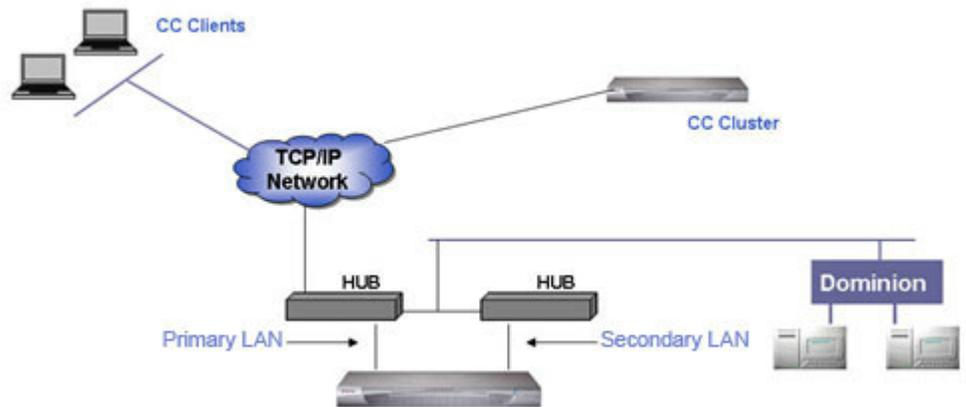
Si le réseau principal est connecté et reçoit un signal d'intégrité de liens, CC-SG utilise ce port LAN pour toutes les communications. Si le réseau local principal perd l'intégrité de liens LAN et que le réseau local secondaire est connecté, CC-SG bascule son adresse IP affectée sur le réseau local secondaire. Le réseau local secondaire est utilisé jusqu'à la remise en service du réseau local principal. Lorsque le réseau local principal est remis en service, CC-SG y retourne automatiquement.
