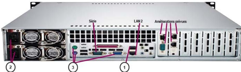
1. Branchez le câble réseau CAT 5 au port LAN 1 sur le panneau arrière de l'unité CC-SG. Branchez l'autre fiche sur le réseau.
