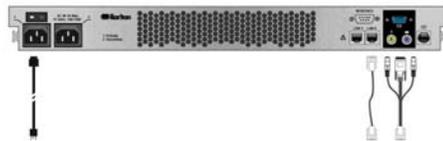
1. Branchez le câble réseau LAN au port LAN 0 sur le panneau arrière de l'unité CC-SG. Branchez l'autre fiche sur le réseau.
