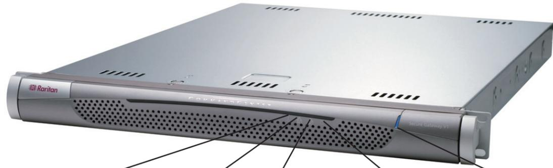
CPU 過熱 LED (紅色) NIC 2 LED (藍色) NIC 1 LED (藍色) 磁碟機 LED (黃色) 電源 LED (藍色)
