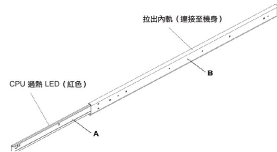
若要移除固定的機身軌道 (A)，當鎖定調整片從軌道組合內部脫離，且鎖住內部軌道時，儘可能將其拉開，直至您聽到喀噠聲。壓下鎖定調整片，將內部軌道完全拉出。對左右兩邊機架軌道組合進行相同的步驟。
