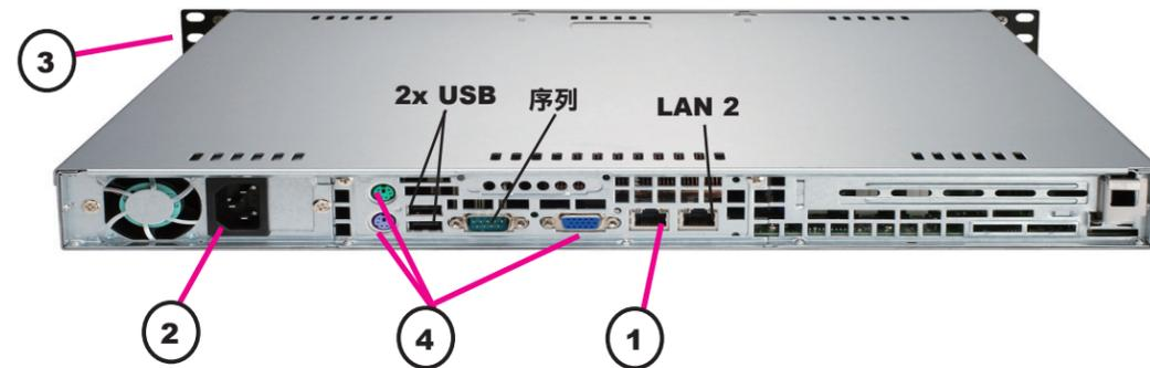
1. 將網路 LAN 電纜連接至 CC-SG 裝置後面板上的 LAN 1 連接埠。將電纜的另一端連接至網路。
