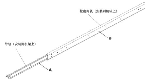
要拆掉固定机箱轨道 (A)，请将其尽量拉出直至听到咔嚓声，这时轨道组件内出现一个锁片将内轨锁定。按下锁片将内轨完全拉出。对左右侧机架轨道组件都执行此操作。
