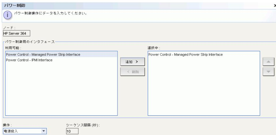
図 18 パワー制御画面 (IPMI サーバノード用)
