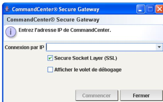
Figure 5 Fenêtre de spécification de l'adresse IP du client lourd
