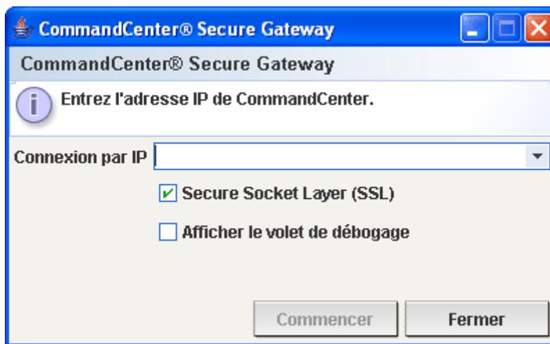
Figure 2 Fenêtre de spécification de l'adresse IP du client lourd
