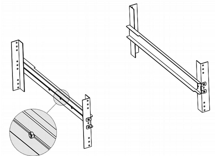
2. Befestigen Sie die Halterungen mit Ihren eigenen Schrauben oder Käfigmuttern an den Rackschienen, und sorgen Sie für eine sichere Verbindung.
