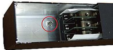
Bei In-Line-Monitoren müssen Sie die Eingangsklemmenblöcke (Monitorrückseite) und die Ausgangsklemmenblöcke (Monitorvorderseite) identifizieren. Jeder Eingangsklemmenblock hat einen entsprechenden Ausgangsklemmenblock.
